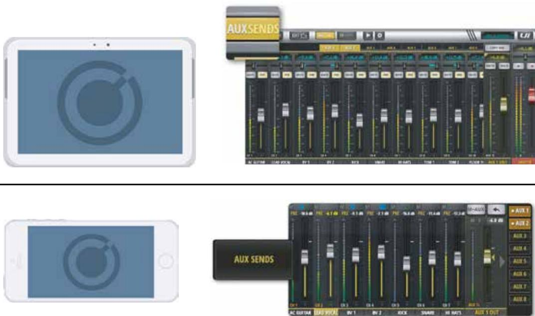
“辅助发送” (AUX SENDS) 页面用于创建适用于监听输出或外置效果器处理的辅助混音信号。辅助主控通道在Ui主机设备上均有专门的输出接口。辅助发送通道推子用于调节各输入通道进入辅助总线的信号量，推子行程采用橙色显示信号水平。Ui24R提供8路辅助主控总线。如需查看或编辑某一通道进入各辅助主控通道的信号量，可导航至该通道“编辑” (EDIT) 页面下的“辅助发送” (AUX SENDS) 选项卡。
