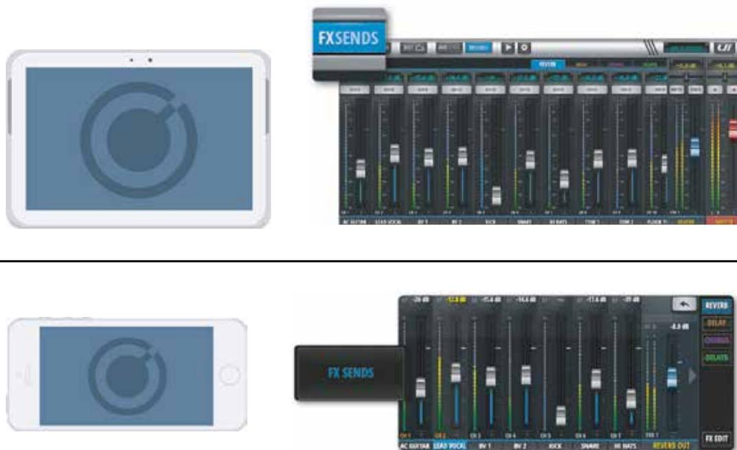
如需查看或编辑所有效果返回（FX RETURNS）通道，平板版本可点击侧拉窗口中的“效果返回”（FX RETURNS）按键，手机版本可点击侧拉窗口中“跳跃到”（JUMP TO）下“效果返回”（FX RETURNS）按键。如通过“调音”（MIX）页面查看，只需滑动“调音”（MIX）页面。
