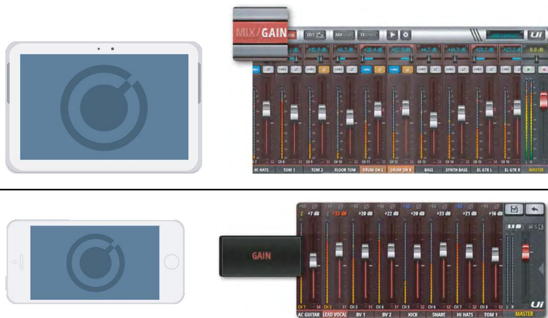
Ui各型号调音台均提供远程增益与幻象电源控制，仅需通过Ui控制软件即可对话筒输入增益与幻象电源进行远程控制，无需接触硬件。
