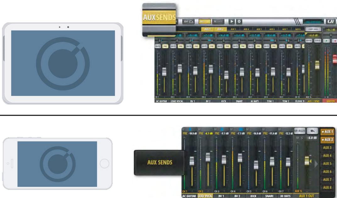
“辅助发送” (AUX SENDS) 页面用于创建适用于监听输出或外置效果器处理的辅助混音信号。辅助主控通道在Ui主机设备上均有专门的输出接口。辅助发送通道推子用于调节各输入通道进入辅助总线的信号量，推子行程采用橙色显示信号水平。最高编号的两条辅助主控通道 (Ui12为“辅助3/4” (AUX3/4)，Ui16为“辅助5/6” (AUX5/6)) 仅限于当“设置” (SETTINGS) 页面的“耳机输出” (HEADPHONE OUT) 设置为“辅助” (AUX) 时方可用于物理输出。
