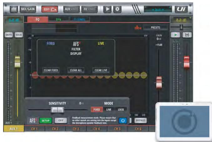
AFS<sup>2</sup>设有“固定” (FIXED) 与“实况” (LIVE) 两种模式。“固定” (FIXED) 模式多用于演出前，对音频系统进行“预热”以确保足够的动态余量。“实况” (LIVE) 模式多用于实况演出，通过不断更新滤波器的位置来实现反馈抑制。
