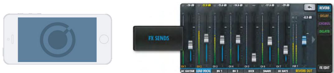
如需查看或编辑所有效果返回（FX RETURNS）通道，平板版本可点击侧拉窗口中的“效果返回”（FX RETURNS）按键，手机版本可点击侧拉窗口中“跳跃到”（JUMP TO）下“效果返回”（FX RETURNS）按键。如通过“调音”（MIX）页面查看，只需滑动“调音”（MIX）页面。
