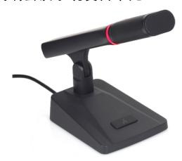
DC992C/D 是一款双音头高品质真数字/ 模拟双备份会议系统单元,搭配两只完全独立的 14毫米直径优质镀金电容音头(一路数字、一路 模拟),有效拾音距离达50厘米以上(视声场环 境而定)。专利的线路设计,使数字部分与模拟 部分完全分离,独立输出,互不干扰,真正实现 数/ 模独立备份双输出。精确计算的蚀刻网罩技 术结合干涉校正技术,能够清晰捕捉每个声音细 节。独特的音头区域腔体设计,配合拾音校正技 术,真实拾取每一个声音细节。特别设计的屏蔽 线路和一体成型锌合金外壳能够有效抑制各类的 电磁干扰,确保拾音清澈干净,满足高质量会议 扩声需求。配有触感柔和的静音按键开关,能够 避免按下开关时带来的机械噪音。状态指示灯环 清晰明亮,方便会场观察工作状态,并具有可根 据需要单独关闭指示灯环的开关。
